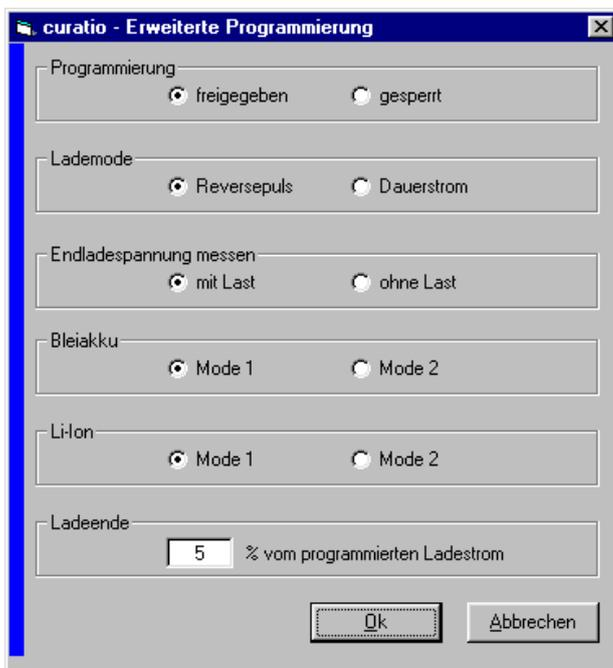
Mit „Programmierung gesperrt“ kann die Programmierung über die Tasten am Ladegerät gesperrt werden. Das Programm am Ladegerät kann dann nur noch über den PC geändert werden.
