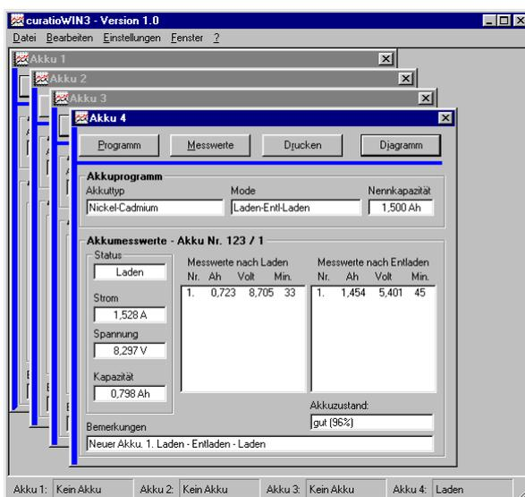
Nach dem Start von „*curatio*WIN3“ werden vom APL das Akkuprogramm und evtl. bereits erfasste Akkumesswerte vom Ladegerät angefordert und angezeigt. Ist kein Ladegerät angeschlossen, erscheint eine entsprechende Meldung. In der Fußzeile des Programmfensters von *curatio*WIN3 wird der Zustand der Kanäle vom Ladegerät angezeigt. Beim *curatio* APL-1 ist nur ein Fenster aktiv, beim *curatio* APL-4 sind vier Fenster aktiv und beim *curatio* APL-4-48V sind zwei Fenster aktiv.
