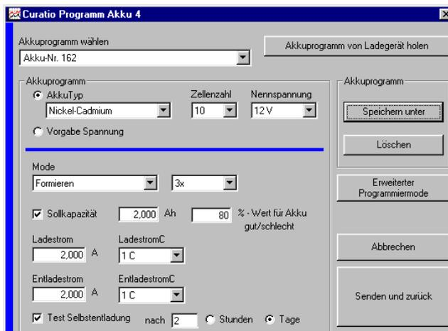
Im Fenster „Programm“ können alle Parameter zum Laden und Entladen der Akkus gesetzt und zum *curatio* APL1/4 gesendet werden.
