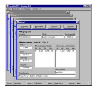
Nach dem Start von "curatioWIN III" werden vom APL-4 das Akkuprogramm und evtl. bereits erfasste Akkumesswerte vom Ladegerät angefordert und angezeigt. Ist kein Ladegerät angeschlossen, erscheint eine entsprechende Meldung. In der Fußzeile des Programmfensters von curatioWIN III wird der Zustand der Kanäle vom Ladegerät angezeigt. Beim curatio APL-1 ist nur ein Fenster aktiv, beim curatio APL-4 sind vier Fenster aktiv.
